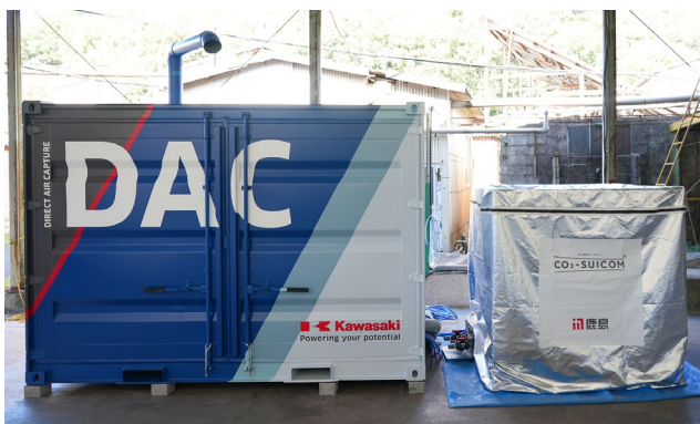
DAC 装置(左)と炭酸化養生槽(右)
