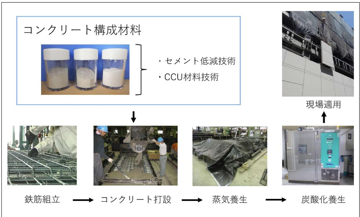
当社が取り組む技術開発は、CO<sub>2</sub> 排出量の削減と CO<sub>2</sub> 固定量を最大化させたカーボンネガティブのプレキャストコンクリートカーテンウォール製品を低コストで量産化できる製造システムの確立を目指すものです。
